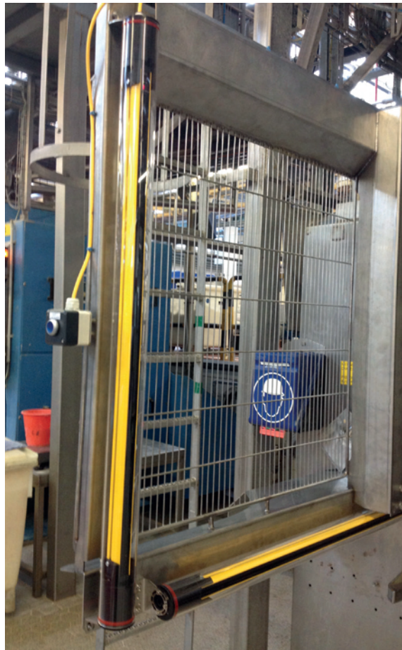
Testopstelling met klassieke veiligheidsoplossing met lichtscherms
